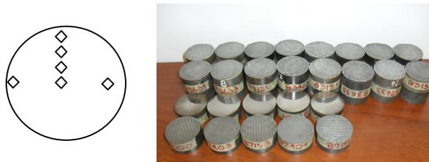
**Figura 1** Probetas usadas en el estudio (der) y esquema de las posiciones usadas para la medición de dureza en la cara plana de las probetas (izq).
