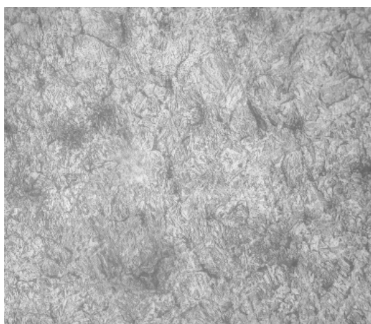
Figura 4. Micrografía con la microestructura general del acero AISI 1045 templado en agua.
