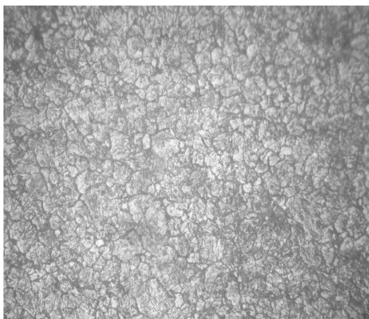
Figura 8. Micrografía con la microestructura general del acero AISI 1045 templado en refrigerante para mecanizado
