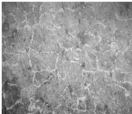
Figura 3. Micrografía con la microestructura del acero AISI 1045 en estado comercial
