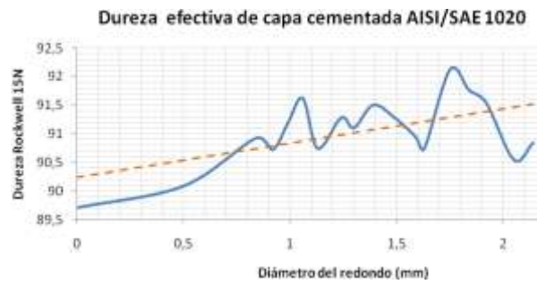
Fig. 3. Durezas de las probetas a) 8620, b) 1020
