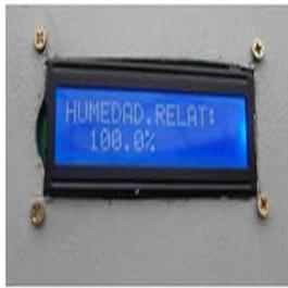
Figura 3. Visualización en pantalla LCD
