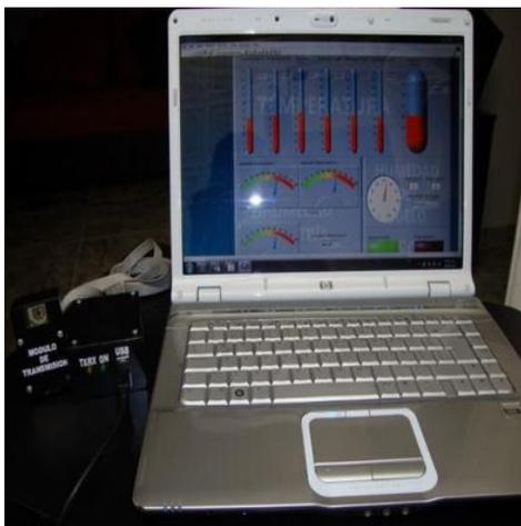
Figura 11. Visualización de señales adquiridas en estación remota.
