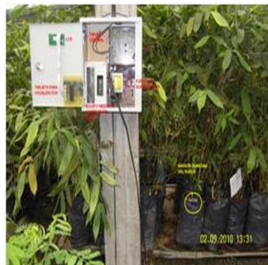
Figura 9. Caja central de adquisición de señales y medición de humedad del suelo.
