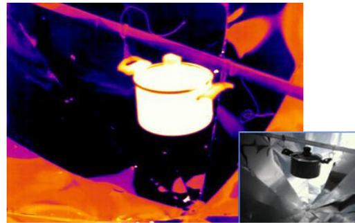
Figura 4. Imágenes termográficas de la cocina solar
