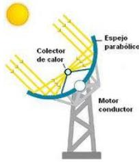
Figura 1. Reflexión de radiación solar sobre punto focal.[8]
