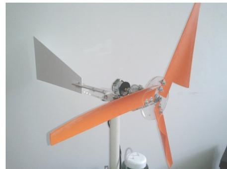
Figura 11. Aerogenerador de pequeña escala
