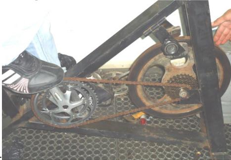
Figura 12. Mecanismo de rotación para generación.
