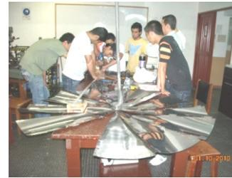
Figura 3. Corte y ensamble cocina parabólica
