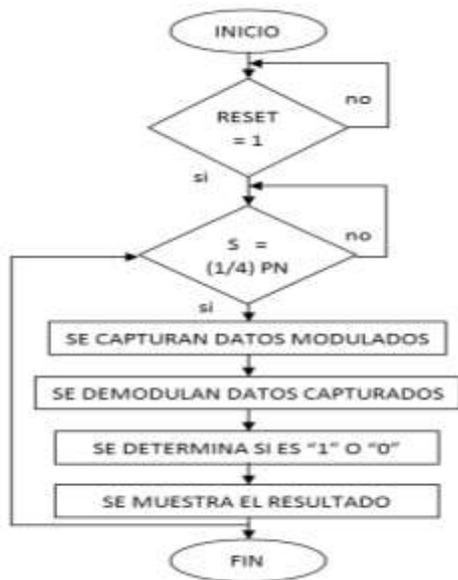
Figura 6. Diagrama de flujo Receptor.
