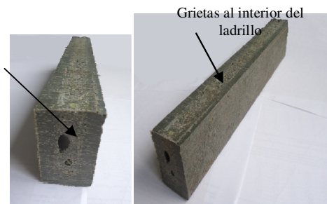
Figura 11. Muestra de plástico extruido (base de probetas), presencia de grietas
