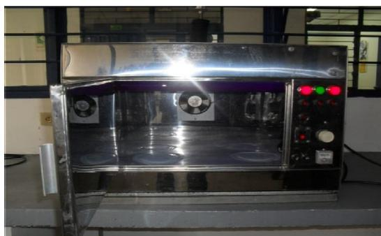
Figura 2. Reactor fotocatalítico tipo batch de tres lámparas de 15 W.
