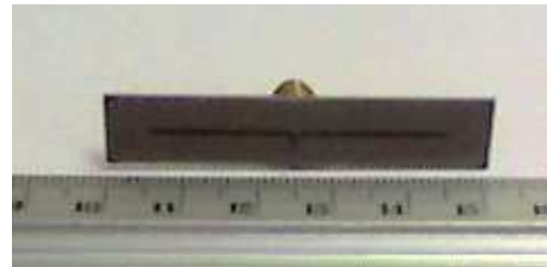
Figura 4. Dipolo alimentado centralmente
