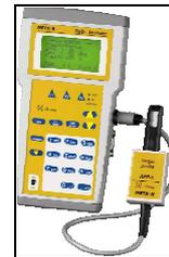
Figura 2. Analizador de Pulsioxímetros SpO<sub>2</sub> METRON DAEG [8].
