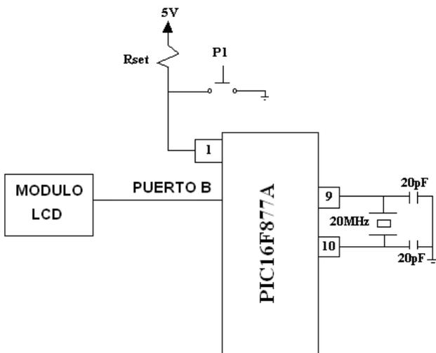
Figura 3.1: Diagrama de conexiones de módulo LCD
