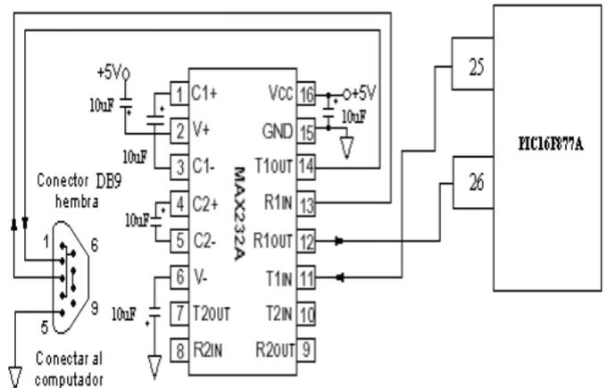
Figura 3.2. Comunicación serial RS-232.
