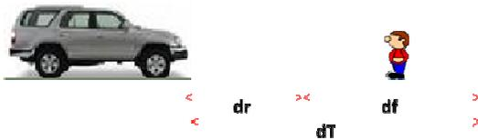
Figura 2. Esquema de la distancia de detención de un vehículo.
