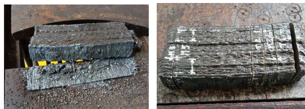
Fig. 8. Precorte de la pared depositada para extraer probetas de tracción.
