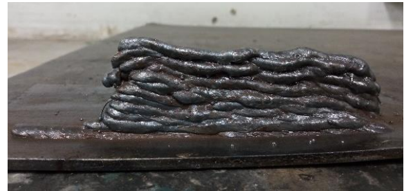
Fig. 3. Resultado de la aplicación inicial de once (11) capas sencillas.
