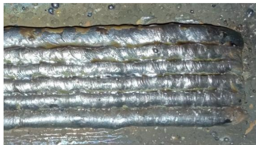
Fig. 6. Depósito para prueba de traslape entre cordones.
