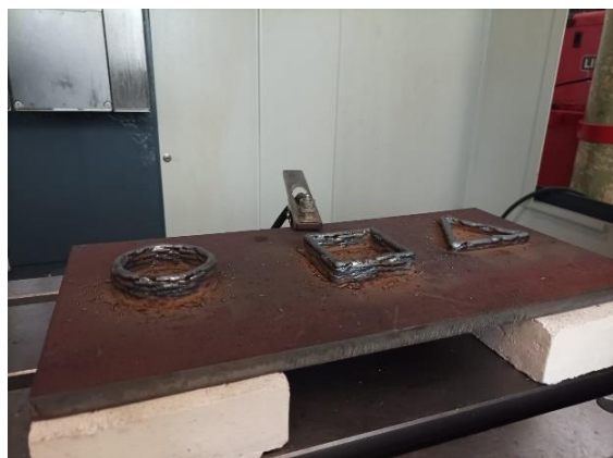
Fig. 4. Depósitos de pared sencilla como prueba de la conexión sincronizada entre CNC y máquina de soldadura.
