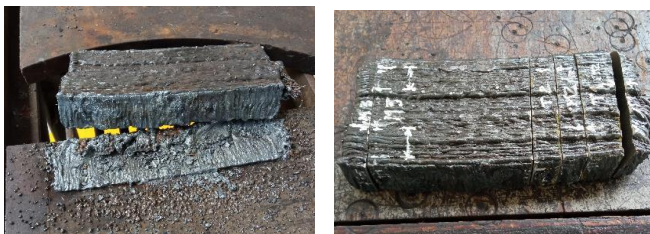
Fig. 8. Precorte de la pared depositada para extraer probetas de tracción.
