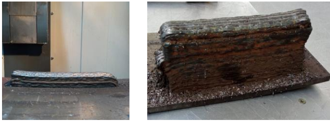
Fig. 7. Pared depositada para extraer probetas de tracción.
