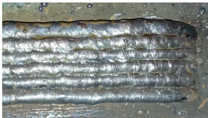
Fig. 6. Depósito para prueba de traslape entre cordones.
