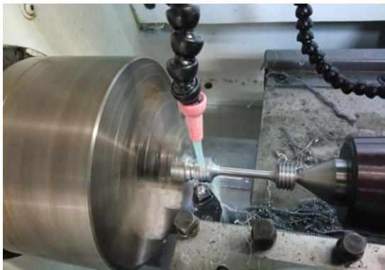
Fig. 9. Mecanizado de las probetas de tracción.
