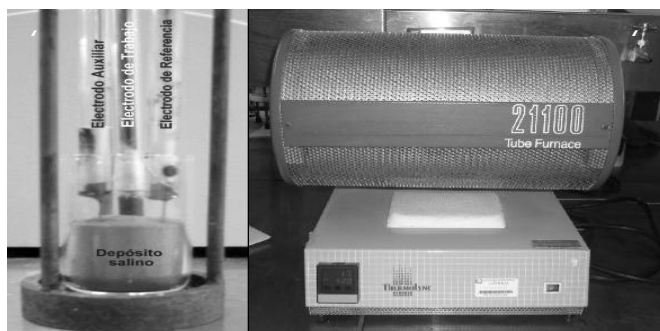
Figura 3. Celda Electroquímica y Horno para Ensayos de Corrosión por Sales Fundidas.
