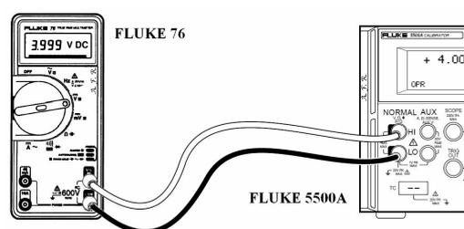
**Figura 1. Esquema de conexión de la calibración.**
