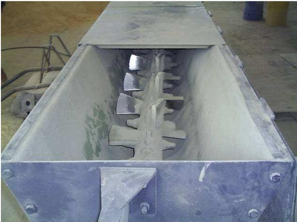
Figura 16. Fotografía del tornillo sinfín del prototipo en operación.
