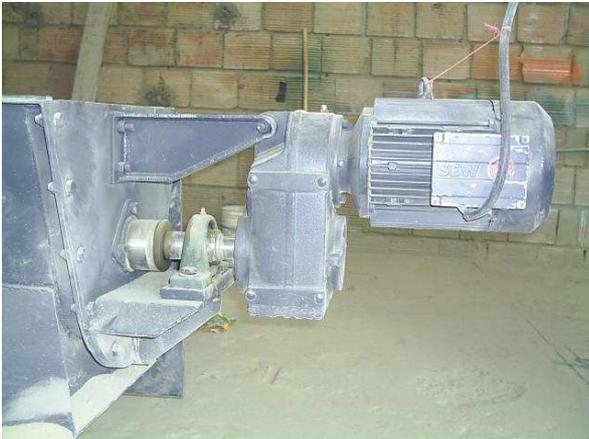
Figura 17. Fotografía de la transmisión de potencia por medio de reductor
