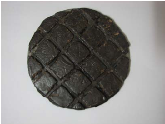
Figura 6. Herramienta con breca utilizada para el pulido del espejo principal.
