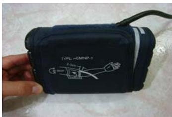
**Figura 3.** Fijación del brazalete al Mandril.
