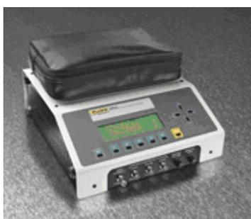
Figura 1. Analizador de presión arterial no invasiva [1].
