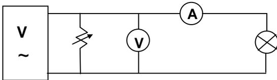
Figura 2. Esquema eléctrico de alimentación del calorímetro.
