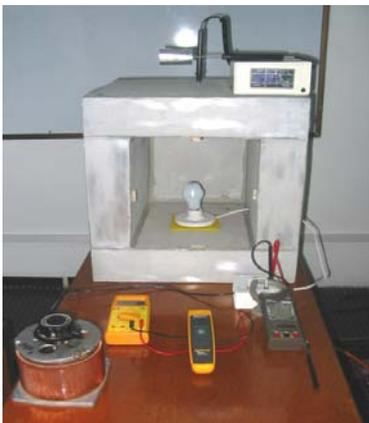
Figura 3. Imágenes del calorímetro, sistema eléctrico e instrumentación.
