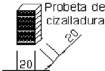
**Figura No. 2 Probetas de cizalladura. Dimensiones en mm.**
