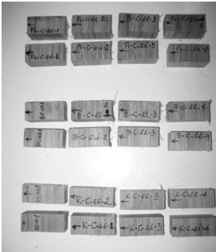
**Figura No. 4. Identificación de probetas para cizalladura.**
