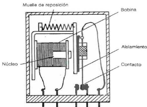
Figura 2. Relé (Introducción a la Electro neumática. Festo)
