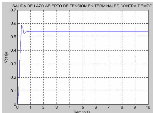
Figura 7. Salida de Voltaje en Lazo Abierto
