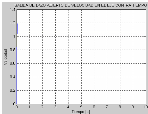
Figura 6. Salida de Velocidad en Lazo Abierto
