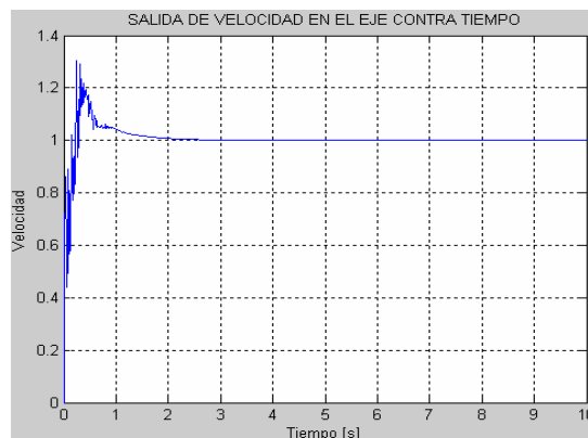
Figura 9. Salida de Velocidad Controlada por un PID
