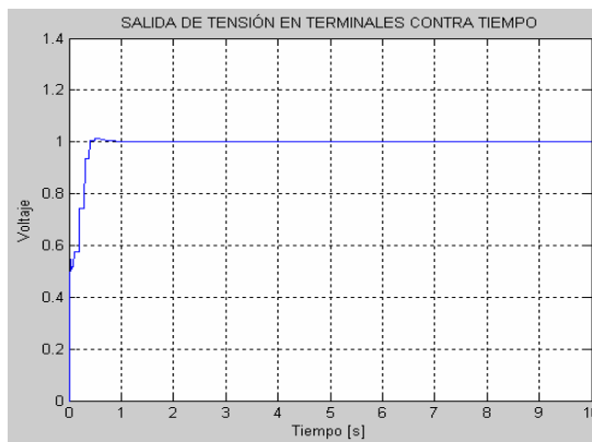
Figura 10. Salida de Voltaje Controlada por un PID
