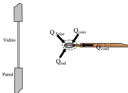
Figura 1. Flujos de calor sobre el sensor.
