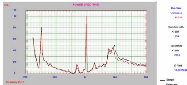
Figura 2. “Inaceptable” Espectro de potencia para mediciones de potencial zeta
