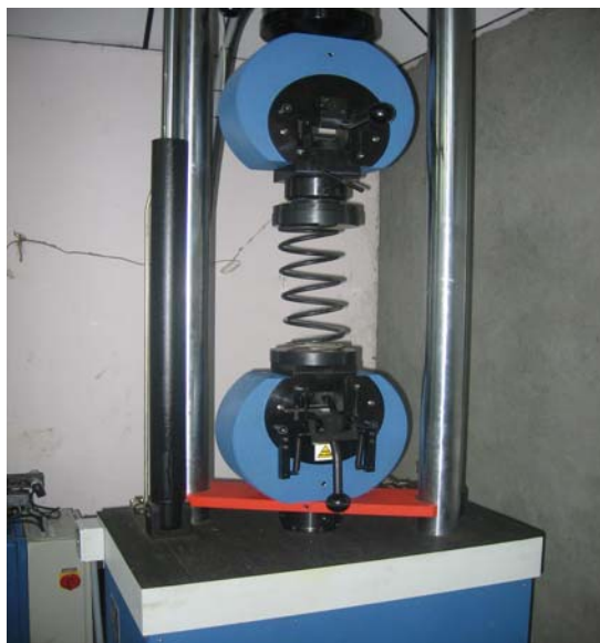
Figura 1 Proceso de ensayo del resorte
