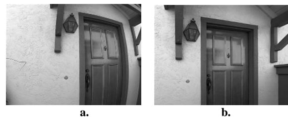
Figura 1. a. Imagen con distorsión b. imagen corregida.
