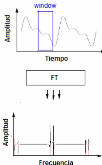
Figura 2. Paso del Dominio en el Tiempo a amplitud en Frecuencia TF
