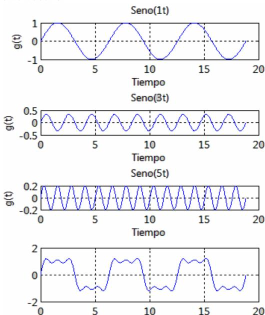
Figura 1. Señal Cuadrada con seis coeficientes
