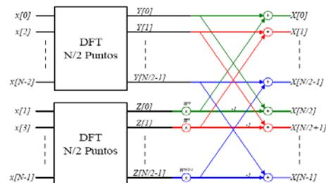
Figura 3. Diagrama Mariposa del Algoritmo de 4 puntos
