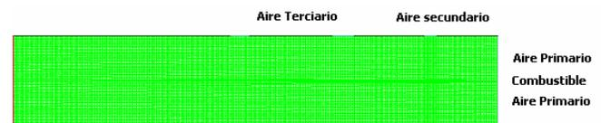
Figura 5. Esquema geometría de la cámara de combustión en 2D realizada en GAMBIT con 29.079 nodos.
