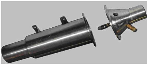
Figura 2. Sistema de alimentación de combustible (boquilla) de la cámara de combustión para una microturbina
