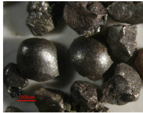
Figura 3. Morfología de las partículas de acero.
