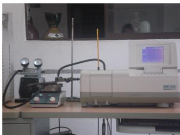
Figura 3. Espectrofotómetro acoplado con control de temperatura
