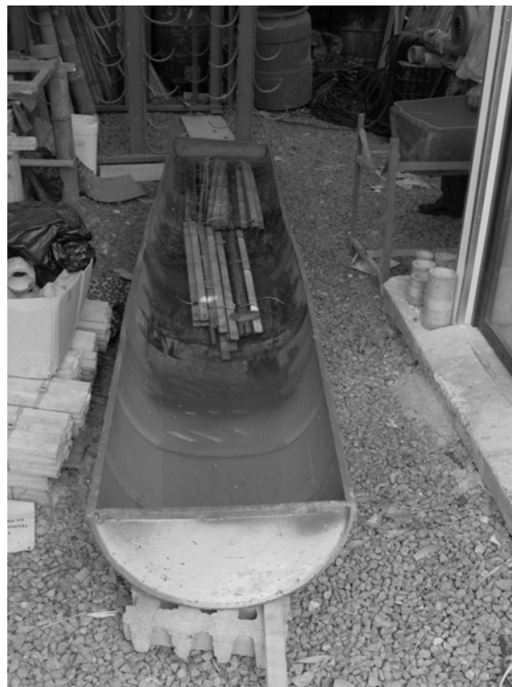
Figura 2. Latas de guadua sumergidas para tratamiento de preservación.
