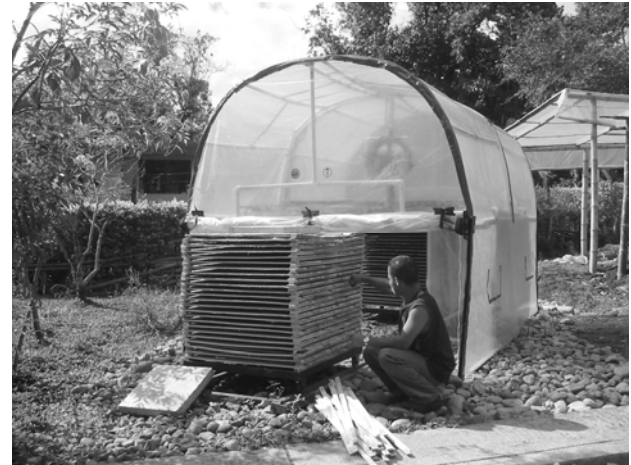
Figura 4. Vista de conjunto del secador solar. Fuente: Autores
