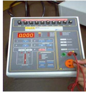
Figura 9. Analizador de Seguridad Eléctrica FLUKE 505 PRO.
