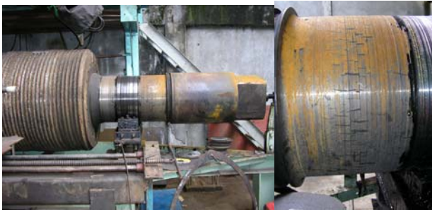
Figura 1. Eje de molino con fisuras longitudinales.
