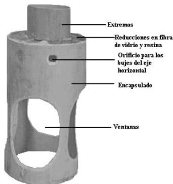
Figura 8. Electrodo y trípode porta electrodo antes del maquinado, sin cubrimiento en cromo
