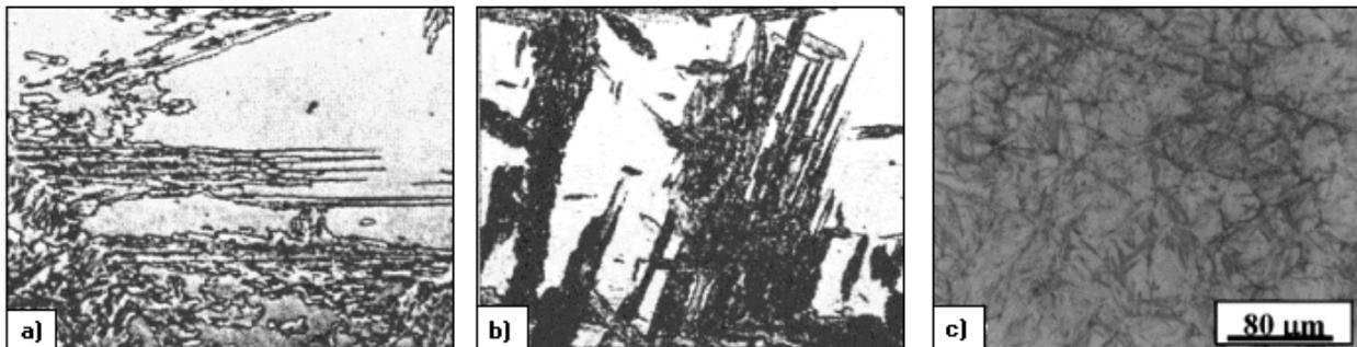
Figura 4. Microestructuras bainíticas. [1].
