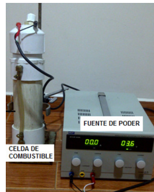
Figura 1: Celda Combustible con Membrana Nafion 117
