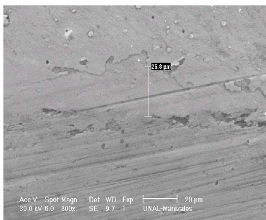
Figura.4. Micrografía de los cráteres formados por el “Calotest” para películas de Zr/ZrN
