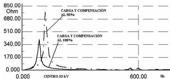
Figura 7. Impedancia vista en una barra de 33 kV.
