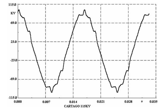
Figura 12. Ondas de tensión en una barra 115 kV.
