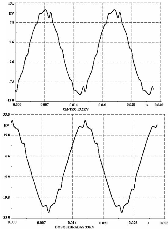
Figura 11. Ondas de tensión en barras de 13.2, 33 kV.
