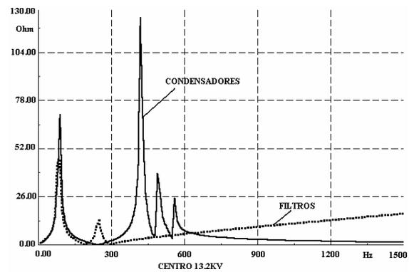
Figura 9. Impedancia vista en barras de 13.2 kV.
