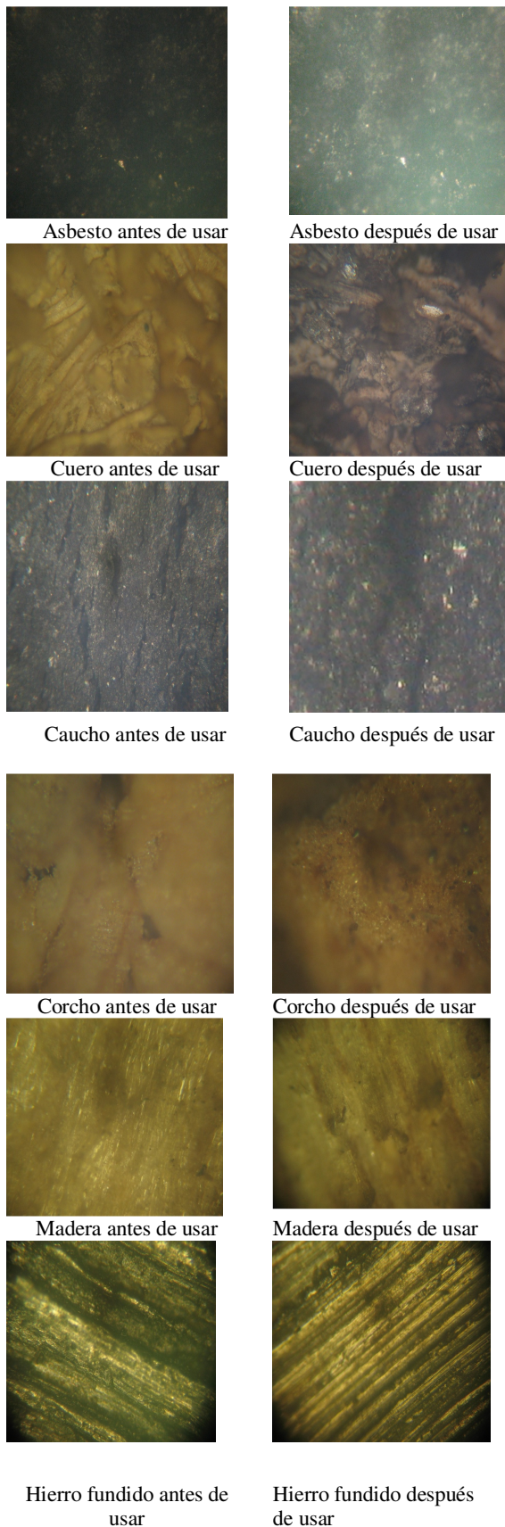
Figura 4. Microscopia óptica de los materiales utilizados tomadas a 200 aumentos
