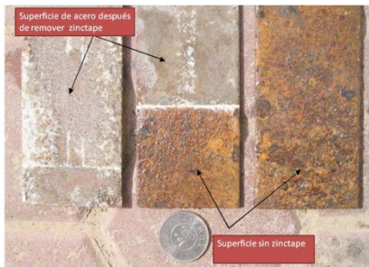
Figura 6. Paneles de acero al carbón, después de 30 días, de exposición al ensayo de inmersión en 5% de solución de NaCl Foto cortesía de Metalnastri-Italia
