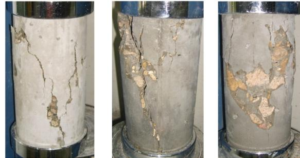
Cilindros de concreto ensayados a compresión
