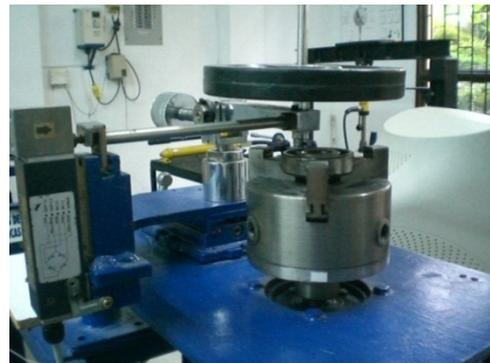
Figura 1. Tribómetro Pin on Disk.
