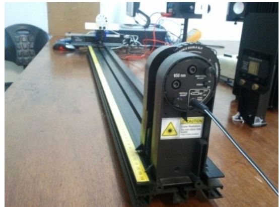
Figura 6. Fotografía del montaje para el experimento de Difracción de Fraunhofer, mediante el kit de Pasco. Luego se apunta el laser a la ranura proyectando sobre una pantalla el patrón de luces y sombras resultante, tal como se muestra en la Figura 7.
