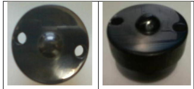
Figura 2. Punzón recubierto con TiAlN.
